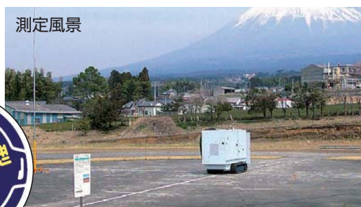
エンジンユニット単体での騒音測定 (社)日本建設機械化協会 測定距離16m
